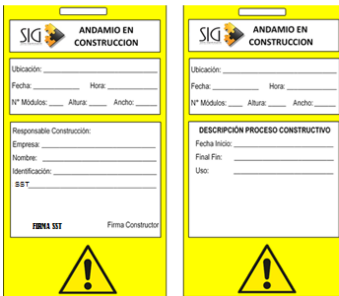
Figura No 6 Tarjetas de señalización “Andamio en Construcción”
