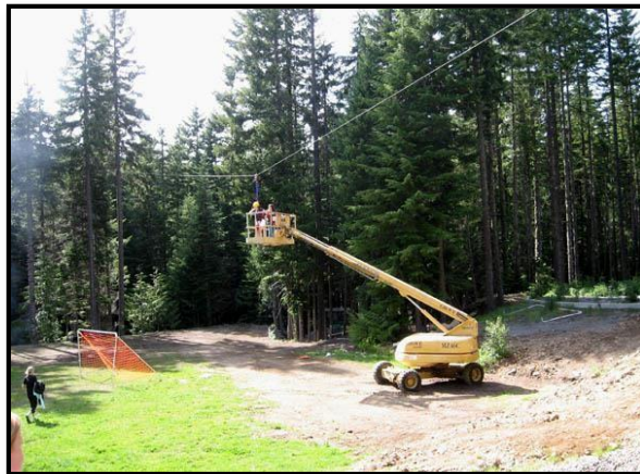
Figura No. 4 Rescate con plataforma elevadora
